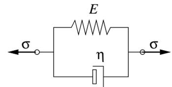
1. Obtener la ecuación diferencial que define el comportamiento de dicho elemento en función de  $(\sigma, \varepsilon)$  y sus derivadas.
