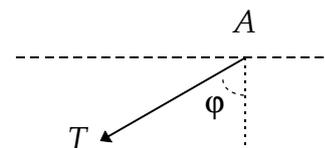
97.- Llamemos  $T_1$  y  $T_2$  a las tensiones respectivas de los ramales vertical e inclinado de la cinta. Tomando momentos en su articulación de las fuerzas que actúan sobre la barra obtenemos que  $T_1 = 3 P$ .
