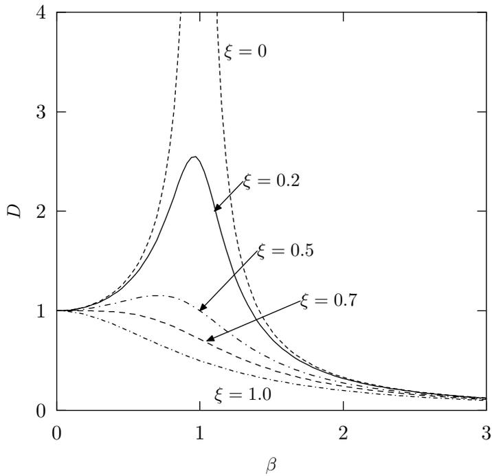
Figura 4.8: Amplitud de oscilación para una excitación armónica, en función de la frecuencia de excitación  $\Omega$ , para diversos valores del amortiguamiento  $\xi$ . Los ejes representan magnitudes adimensionales, en abscisas  $\beta = \Omega/\omega_0$ , y en ordenadas  $D = A/(q/k)$  (factor de amplificación dinámica).
