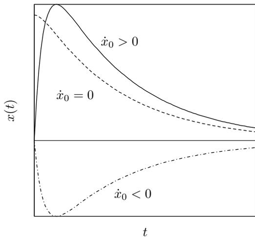
Figura 4.4: Movimiento de un sistema definido por la ecuación  $m\ddot{x} + c\dot{x} + kx = 0$ , con amortiguamiento supercrítico ( $c > 2\sqrt{km}$ ), bajo distintas condiciones iniciales; Caso I)  $\dot{x}_0 > 0$ , Caso II)  $\dot{x}_0 = 0$ , Caso III)  $\dot{x}_0 < 0$ .
