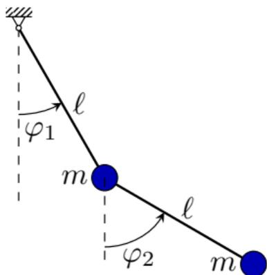
Péndulo doble formado por masas puntuales  $m$  unidas por varillas sin masa de longitud  $l$
