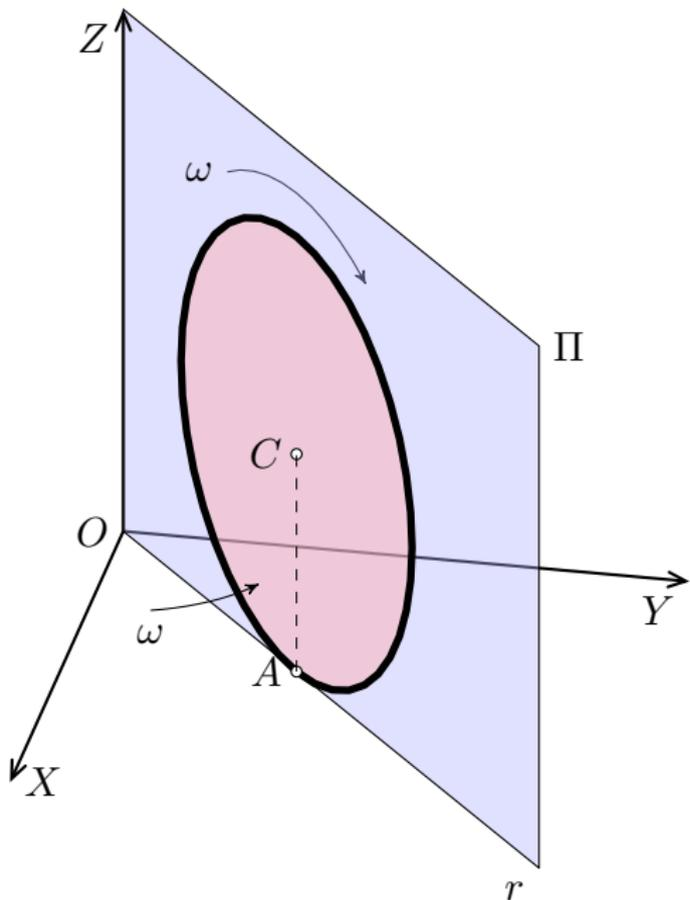
Plano  $\Pi$  que gira alrededor del eje  $OZ$  con velocidad angular  $\omega$  constante. A su vez un disco de radio  $R$  se mantiene dentro de este plano, rodando sin deslizar sobre la recta móvil  $r$  intersección de dicho plano  $\Pi$  con  $OXY$ , con la misma velocidad angular  $\omega$ .
