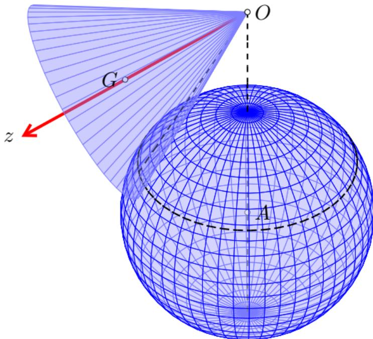
Cono de revolución con semiángulo  $30^\circ$  cuyo vértice  $O$  se mantiene fijo; se mueve manteniéndose en contacto con una esfera fija de radio  $R$ , rodando sin deslizar.
