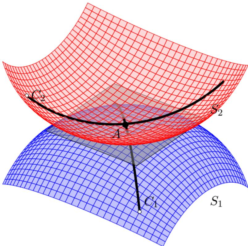
*Sólidos tangentes  $S_1$  y  $S_2$ , con deslizamiento; se dibuja la huella dejada por el punto de contacto  $A$  sobre cada uno.*
