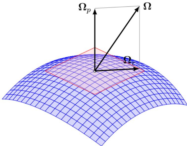
*Sólidos tangentes con rodadura sin deslizamiento: componentes de rodadura y pivotamiento de la velocidad de rotación,  $\Omega = \Omega_p + \Omega_r$ .*
