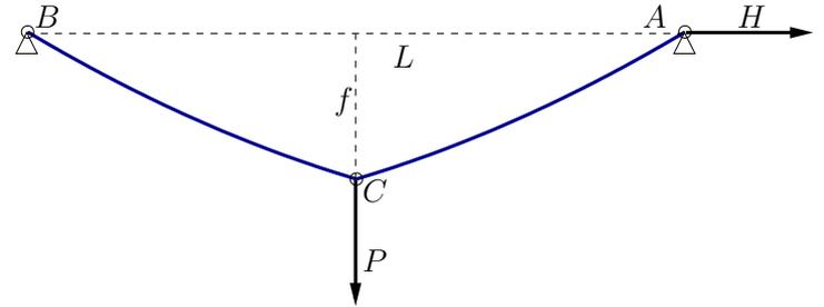
1. Longitud  $S$  del cable entre  $A$  y  $B$ , así como la flecha  $f$  del cable (distancia vertical máxima por debajo de  $AB$ ), expresadas ambas en función de  $L$ .
