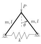
El trabajo virtual realizado por las fuerzas  $F_i$  para cualquier conjunto de desplazamientos virtuales  $\{\delta r_i\}$  se define como:  $\delta W = \sum_{i=1}^N F_i \cdot \delta r_i$ .
