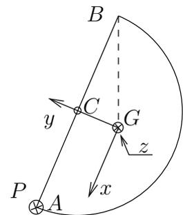
El momento de la percusión en  $G$  es  $\mathbf{r}_{GA} \wedge \mathbf{P}$ , contenido en el plano de la placa. El eje perpendicular  $Gz$  es principal de inercia de la placa, por lo que la velocidad de rotación  $\Omega$  producida por la percusión no tendrá componente según dicho eje, estará igualmente contenida en el plano. Por consiguiente, la velocidad de cualquier punto de la placa,  $\mathbf{v}_G + \Omega \wedge \mathbf{r}$ , es necesariamente perpendicular a la misma.
