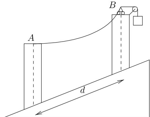
El cable forma una catenaria cuyo parámetro se obtiene de forma directa mediante:
