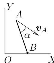
Los enlaces (mecanismos que restringen el movimiento de un sistema) se pueden clasificar, entre otros criterios, en *holónomos* y *anholónomos*. Se consideran holónomos cuando es posible expresar la condición de ligadura mediante una relación entre las posiciones de las partículas (o bien las coordenadas generalizadas) y el tiempo exclusivamente:
