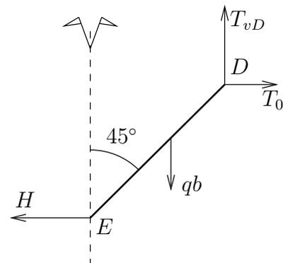
Considerando ahora el tramo del cable  $BD$ , de la tensión horizontal (3)<sub>2</sub> se obtiene el parámetro de esta catenaria:
