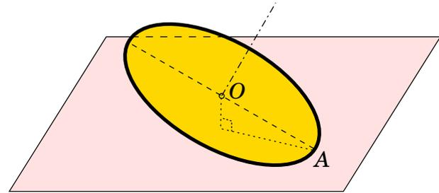
1.— Consideramos un triedro móvil  $Oxyz$ , siendo  $Oz$  el eje de revolución,  $Ox$  según el diámetro horizontal y  $Oy$  según el de máxima pendiente. Por las simetrías existentes, son principales de inercia. El tensor central de inercia es
