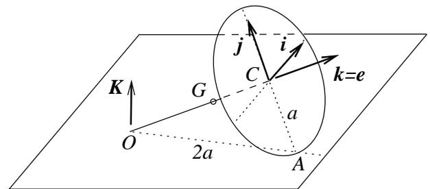
Denominando  $(\Omega_y, \Omega_z)$  a las componentes de la velocidad de rotación del sólido según las direcciones anteriores ( $\Omega_x$  es nula por la condición de apoyo), el momento cinético es
