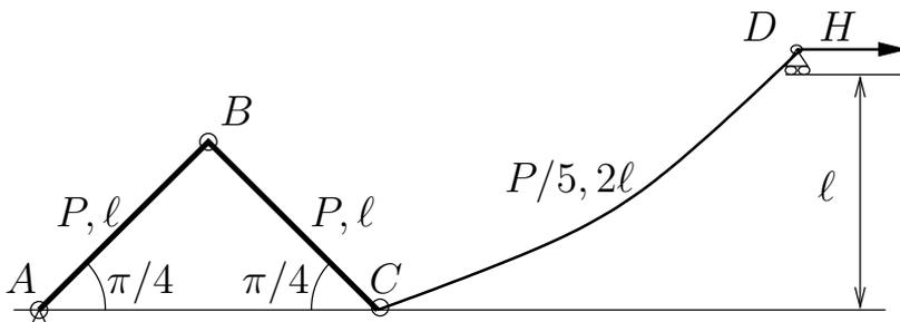
1. Comprobar que la configuración en que  $AB$  y  $AC$  forman  $\pi/4$  con la horizontal es una posición de equilibrio para el valor dado de  $\mu$ , y calcular las reacciones en  $A$  y  $C$ .
