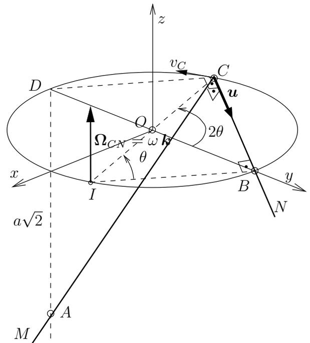
Debemos tener en cuenta por otra parte que la velocidad de rotación de la escuadra será la composición de la velocidad de rotación del segmento  $CN$ ,  $\Omega_{CN}$ , y una rotación alrededor de la propia recta  $CN$ , de forma que  $CM$  se mantenga sobre  $A$ . Esta otra componente de la rotación la calcularemos en el apartado siguiente.
