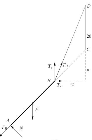
2.— Si el cable pesa formará un arco de catenaria entre B y D. Las condiciones del equilibrio de la barra AB no cambian, por lo que la tensión del cable en B será la misma calculada en el apartado anterior. La ecuación de la catenaria será
