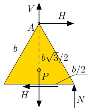
2.— Supondremos como hipótesis de partida que el vértice de la catenaria se sitúa entre  $A$  y  $B$ , cuyas abscisas en los ejes propios de la catenaria serían  $x_A < 0$  y  $x_B$ . De esta forma la carga vertical sobre el vértice del cono sería  $V = -T_{zA} < 0$ . Esto no implica pérdida de generalidad, ya que si eventualmente se obtiene  $x_A > 0$  simplemente indicaría que el vértice estaría situado a la izquierda de  $A$ , y  $V$  sería positiva.
