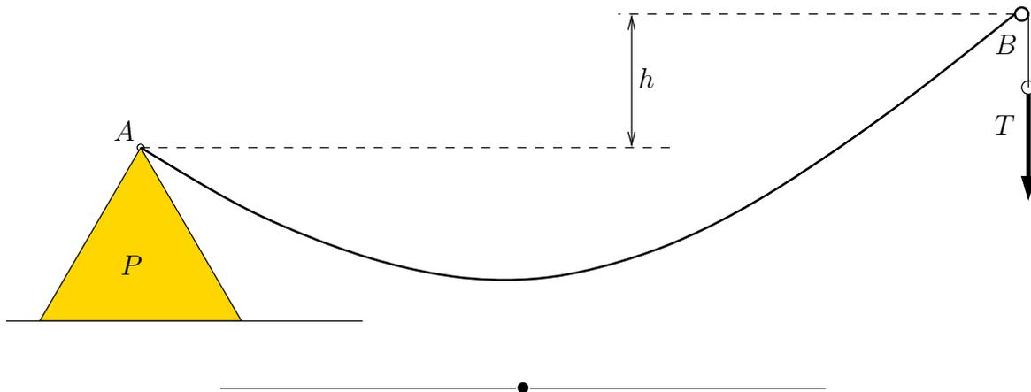
1.— Denominando  $(H, V)$  las acciones horizontal y vertical respectivamente sobre el vértice del cono, y  $b$  la generatriz del cono (que como veremos no influye en los resultados), la condición de límite de vuelco se produce cuando la reacción normal en la base resultante  $N$  se ha desplazado hasta la esquina. Aplicando el equilibrio de momentos en este punto:
