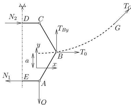
1.— Debido a la simetría existente sólo se analiza la mitad de la estructura, tal y como se muestra en la figura adjunta. Aislando el sistema formado por las barras  $EA$  y  $AB$ , e imponiendo que el momento de las fuerzas en  $B$  es nulo, se obtiene  $N_1$ :
