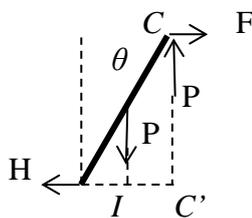
La reacción  $H$  en  $B$  entre las dos barras debe ser horizontal, por la simetría existente.
