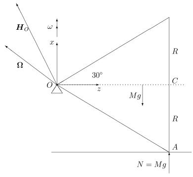
En el movimiento del cono, el vector  $\mathbf{H}_O$  conserva el módulo y permanece en el plano vertical Oxz, describiendo un cono de eje vertical con velocidad  $\omega \mathbf{i}$ . Por tanto su derivada es
