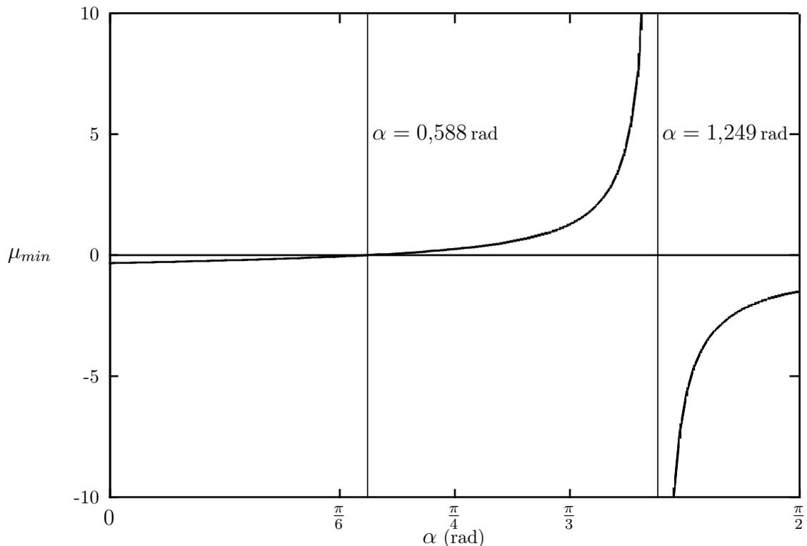
Representación gráfica del valor del coeficiente de fricción  $\mu_{min}$ .
