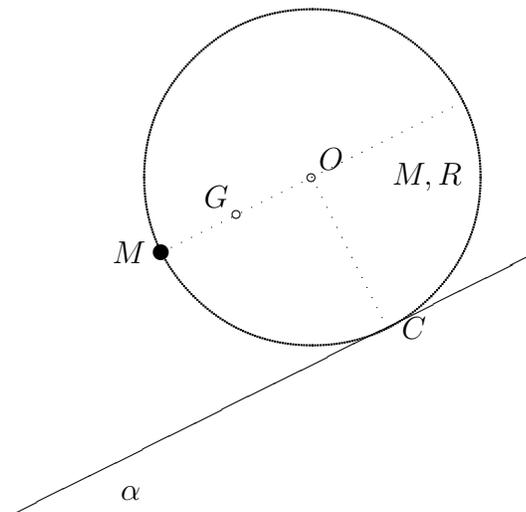
El sistema, al no deslizar, posee un único grado de libertad, el ángulo  $\theta$  girado por el sólido. El primer apartado se reduce a obtener la ecuación que expresa la aceleración angular  $\dot{\omega} = \ddot{\theta}$  en el instante inicial.
