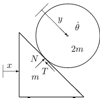
Tomamos como grados de libertad  $x$ , desplazamiento horizontal del triángulo, e  $y$ , desplazamiento del disco relativo al triángulo en dirección de la hipotenusa. El ángulo de rotación es
