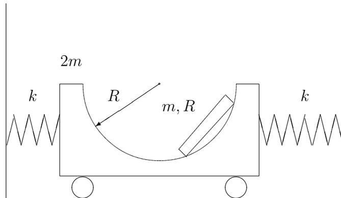
Tomamos las coordenadas generalizadas  $(x, \theta)$ , siendo  $x$  el desplazamiento del carretón y  $\theta$  el ángulo absoluto girado por la varilla, medidos ambos a partir de la posición de equilibrio estable.
