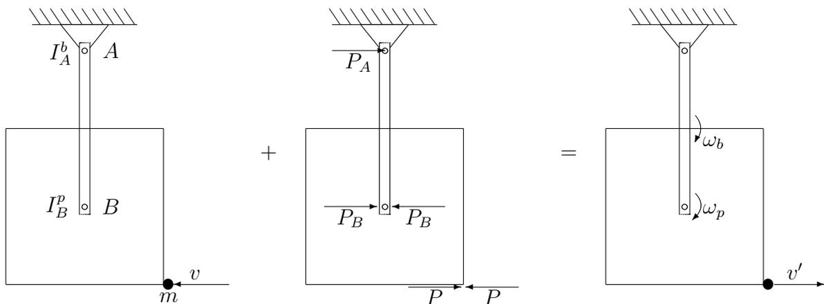
El movimiento después de la percusión queda determinado por las incógnitas  $(\omega_b, \omega_p, v')$ , para las que se toman como positivos los sentidos indicados en la figura. Expresamos en primer lugar el balance del momento cinético del conjunto (placa, barra y partícula) en el punto  $A$ , de forma que la única percusión exterior a este sistema ( $P_A$ ) no interviene:
