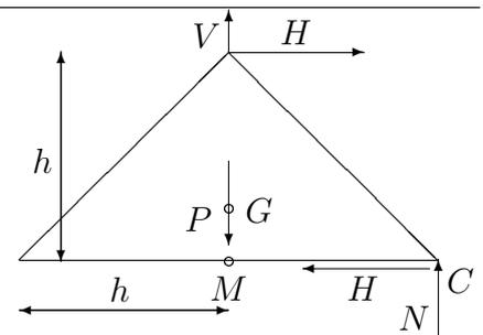
1. *por vuelco*; expresando el equilibrio de momentos en el centro de la base ( $M$ ), para que el cono no vuelque el momento activo producido por  $H$  debe ser equilibrado por el momento pasivo debido a la reacción  $N$ , que puede desplazarse hacia la derecha hasta situarse como máximo en el vértice  $C$ :
