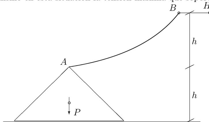
1.- El cable ejerce sobre el vértice del cono unos esfuerzos  $H$  (horizontal) y  $V$  (vertical). La reacción normal del plano es pues  $N = P - V$ , mientras que la horizontal es  $H$ . Al tirar del cable y aumentar  $H$  paulatinamente, el equilibrio se puede romper de una de las dos maneras siguientes:
