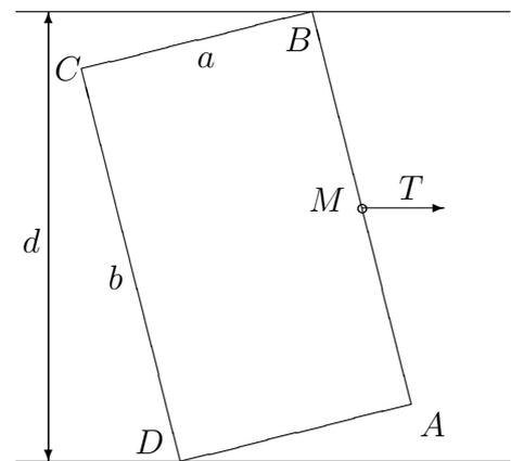
Una vez que se ladea el cajón, adquiere la configuración de la figura, en contacto mediante las esquinas  $D$  y  $B$  con los paneles. La recta de acción de la fuerza  $T$  es la recta  $MG$ , con lo que para el equilibrio las reacciones  $R'_D$  y  $R'_B$  en las esquinas deben cortar a esta recta en un mismo punto  $G$ . Este debe estar situado a la izquierda del punto  $E$ , puesto que las reacciones tangenciales  $T_D$  y  $T_B$  deben estar orientadas hacia la izquierda.
