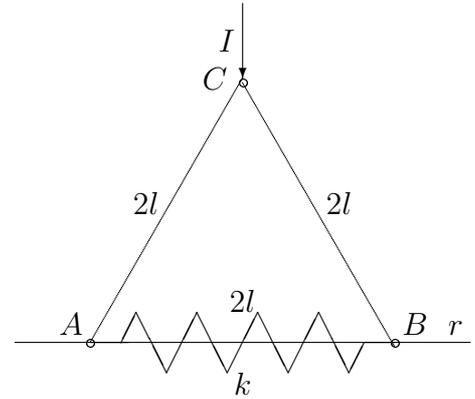
La simetría existente respecto al eje  $Oy$  permite asegurar que  $C$  se moverá según la dirección del mismo, y los puntos  $A$  y  $B$  tendrán movimientos simétricos respecto del eje. Podemos estudiar pues tan sólo la barra  $BC$ , sobre la que repercutirá una percusión  $I/2$ , y a su vez sufrirá las percusiones reactivas  $Q$  (debido a la barra  $AC$ ) y  $P$  (debido al enlace de la recta  $r$ ).
