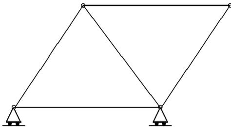
Dejando al margen la sustentación, se trata de una *estructura internamente isostática* ( $n = 4$ ,  $b = 5$ ,  $2n = 3 + b$ ), ya que no posee ningún grado de libertad interno. Sin embargo, la sustentación es insuficiente, existiendo un grado de libertad (traslación horizontal del conjunto como un sólido rígido), por lo que en su conjunto el sistema *no constituye propiamente una "estructura"*.
