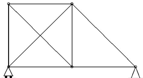
La sustentación es isostática, pero el sistema constituye una *estructura hiperestática*. Comprobamos que ( $n = 5$ ,  $b = 8$ ,  $2n < 3 + b$ ), por lo que existen barras redundantes en la estructura. En concreto, de eliminarse una de las dos diagonales del cuadrado resultaría una estructura isostática.
