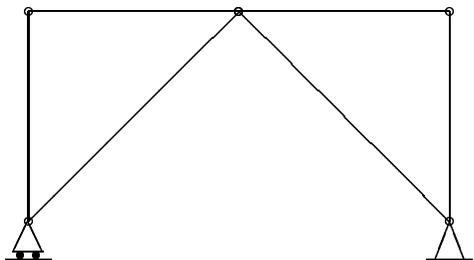
En este caso la sustentación sí es suficiente (isostática), pero en cambio el sistema de barras es un *mecanismo*, al poseer un grado de libertad interno (rotación alrededor de la rótula central). Comprobamos que ( $n = 5$ ,  $b = 6$ ,  $2n > 3 + b$ ), hay insuficientes barras para restringir el movimiento interno.
