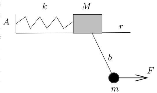
La fuerza generalizada  $Q_i$  es el coeficiente de  $\delta q_i$  en la expresión del trabajo virtual. Su valor es  $\Sigma \mathbf{f}_j \cdot \partial \mathbf{r}_j / \partial q_i$ , y si las fuerzas derivan de un potencial  $V$ ,  $Q_i = -\partial V / \partial q_i$ .
