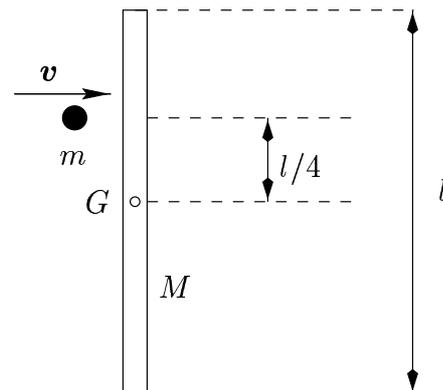
El número de incógnitas en general son 5: las dos componentes de la velocidad de la partícula después del choque ( $\mathbf{v}'$ ), las dos componentes de la velocidad del CDM del sólido ( $\mathbf{v}_G$ ), y la velocidad angular del sólido ( $\Omega \mathbf{k}$ ). Sin embargo, considerando que la impulsión se produce según la dirección de la normal  $\mathbf{n}$ , se deduce inmediatamente que las componentes tangenciales de las velocidades de la partícula y de  $G$  deben conservarse:
