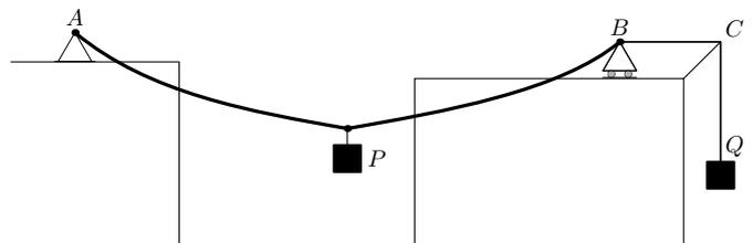
1.- El contrapeso  $Q$  es la tensión horizontal de la catenaria  $AB$ . De ahí se obtiene el parámetro de la catenaria:
