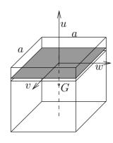
Por las simetrías existentes, los momentos de inercia respecto de las otras dos direcciones de la figura son iguales ( $I_{uu} = I_{vv} = I_{ww}$ ), siendo además las tres direcciones principales de inercia. El tensor central de inercia es por tanto esférico, siendo sus componentes en cualquier triedro
