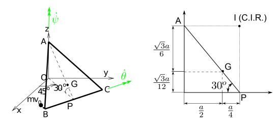
En el sistema formado por la placa triangular y la partícula imponemos que la suma de las impulsiones externas es igual a la variación de la cantidad de movimiento de dicho sistema:
