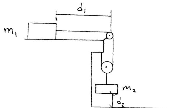
1. Aplicando el principio de los trabajos virtuales, obtener el valor mínimo  $\mu_0$  del coeficiente de rozamiento para que el sistema esté en equilibrio.
