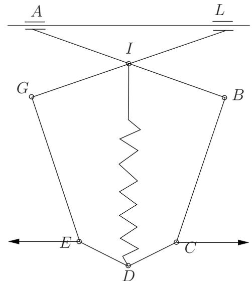
1. Utilizando el principio de los trabajos virtuales obtener las ecuaciones que nos dan el valor de los parámetros, que mantienen a la estructura en equilibrio.
