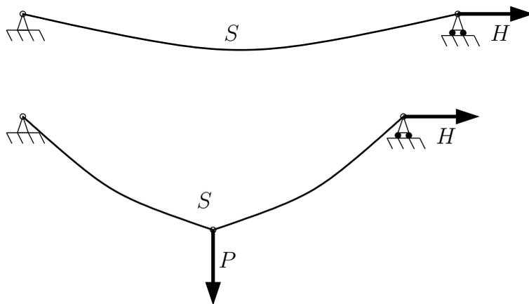
1. Obtener la configuración de equilibrio del cable, calculando la luz horizontal entre apoyos  $L$  y la flecha en el centro  $f$  en función de  $S$ .
